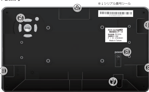
⑤操作ボタン(十字キー) ⑥LED OUT 端子(L/R) ⑦DC IN(電源コネクタ) ⑧SDメモリーカードスロット ⑨電源スイッチ ⑩USB2.0接続端子 ※10UTの背面にはスタンドが付属しています。
