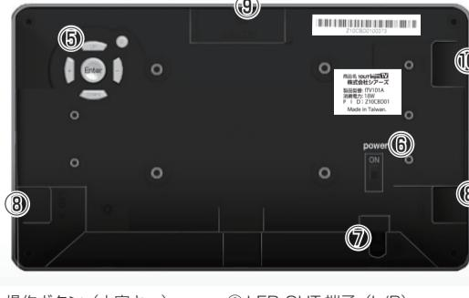
⑤ 操作ボタン（十字キー） ⑥ POWER（電源スイッチ） ⑦ DC IN（電源コネクタ） ⑧ LED OUT 端子（L/R） ⑨ SDメモリーカードスロット ⑩ USB2.0 接続端子
