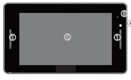
① スピーカー ② LCD ③ 電源 LED ④ リモコン受光部
