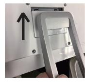
モニターの背面に差し込み上方向に スライドさせます。
