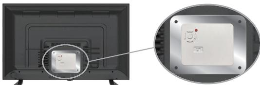
モニター背面に、本機裏面のマグネットにて固定します。オプションの取付金具を使用して取り付けることもできます。
